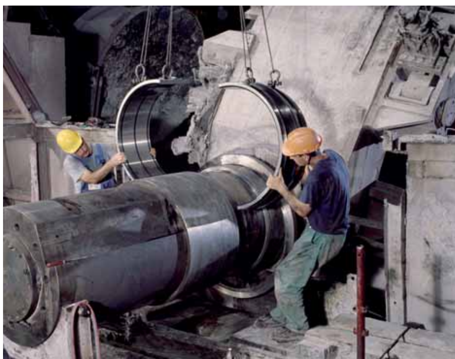
Монтаж крупногабаритного разъемного сферического роликоподшипника
