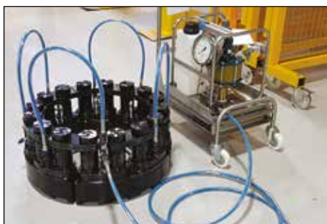
◀ Система одновременной затяжки шпилек Enerpac (MST) способна одновременно выполнять затяжку всех шпилек в соединении.
