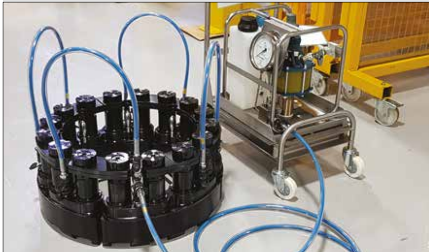
▲ Установка и подготовка к работе системы группового натяжения шпилек.
