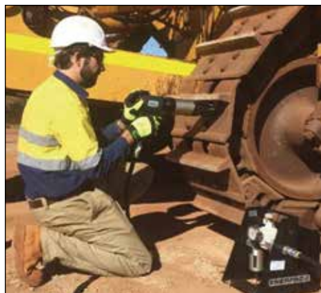
◀ Гайковерт PTW1000 позволяет легко справиться с техническим обслуживанием таких фланцев.
