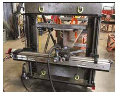
Фрезерование торца двутавровой балки с помощью GMRF1000. ►
