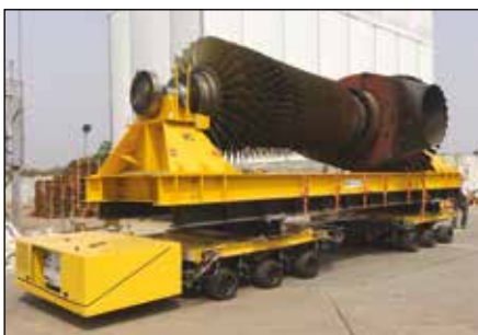
Транспортировка ротора турбины
