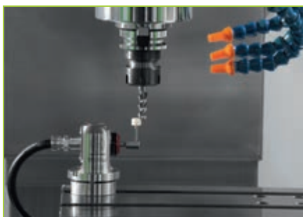
Датчик настройки и привязки инструмента (опция)
