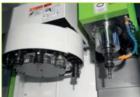
Система смены инструментов зонтичного типа, 12 позиций
