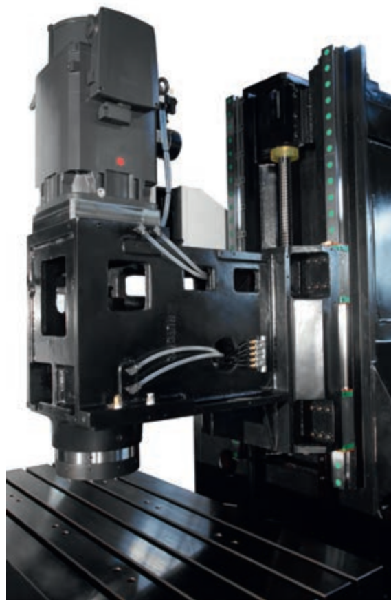
Применение чугуна, отпущенного для снятия напряжений, обеспечивает устойчивость конструкции без деформаций
