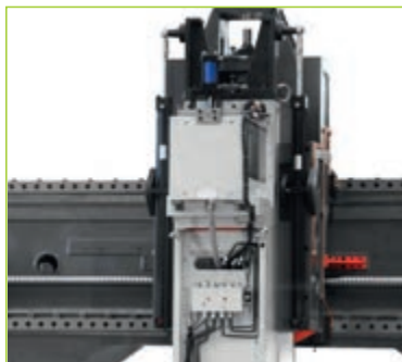
Гидравлическая система балансировки на оси Z
