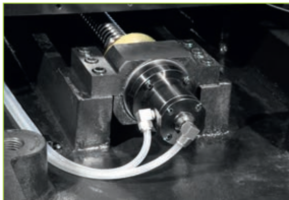
Система масляного охлаждения ШВП (VF1100, VF1300 и VF1500)
