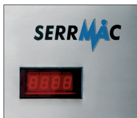
Цифровой счетчик оборотов шпинделя для вариатора
