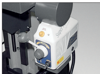
Код 40026 Power: Автоматическая механическая продольная подача стола.
