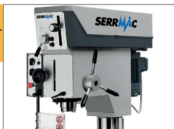
Код 40083: Автоматическая подача за счет э/м сцепления при 24 В пост. тока
