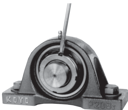
Рис. 14.8. Загибание наружного зубца шайбы (Контрение стопорной гайки)
