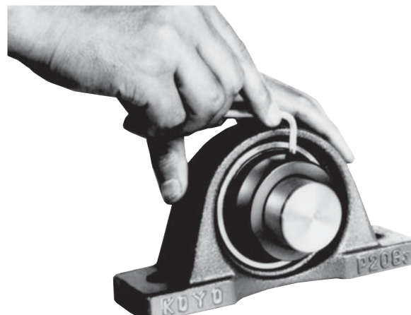
Рис. 14.10. Монтаж эксцентрикового стопорного кольца
