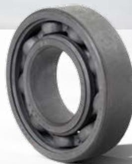
**Серия F6XX** предназначена для использования в условиях экстремально высоких температур (350°C) на низких скоростях вращения (максимум 50 оборотов в минуту) и используется, например, в печных вагонетках для изготовления фарфора или строительных материалов, в сталелитейной и стекольной промышленности.
